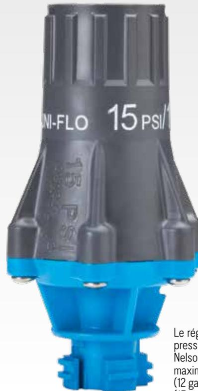
Le régulateur de pression universel de Nelson affiche un débit maximum de 2,7 m<sup>3</sup>/h (12 gal/min) à 1,0 bar (15 psi) et au-delà.
